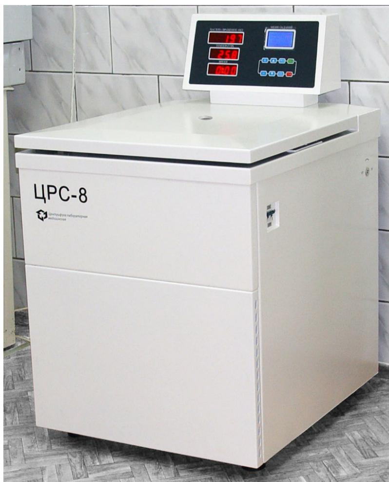
ЦРС-8 является центрифугой рефрижераторной, с термостатированием\*, стационарной с частотой вращения вала до 8000 об/мин и рассчитанной для работы в закрытых помещениях лабораторного типа с искусственно регулируемыми климатическими условиями: отапливаемые, вентилируемые, защищенные от прямого воздействия атмосферных осадков, солнечной радиации, песка, пыли, с температурой окружающего воздуха от + 5 до +40°С и верхним значением относительной влажности воздуха 90%.
