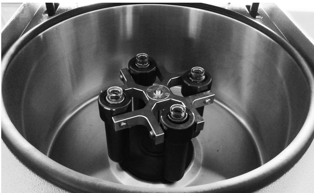
Ротор 4x100 с пробирками в камере центрифуги ЦН-4000
