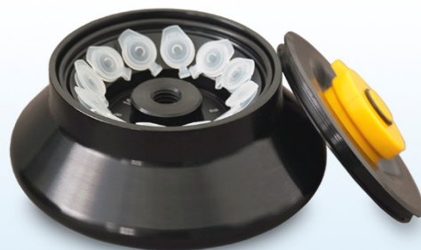
Ротор 12x1,5/2,2 мл Частота вращения 20 000 об/мин Фактор разделения (ОЦУ) 26 800 K-фактор 388
